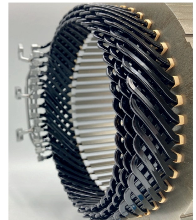
Abbildung 14: Hairpin-Stator mit Wellenwicklung aus Aluminium-Lackdraht vom Lehrstuhl PEM der RWTH Aachen
