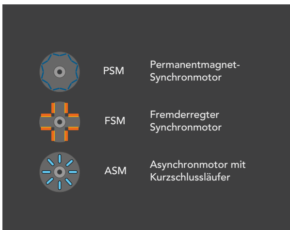
Abbildung 14: Schematische Darstellung Rotor
